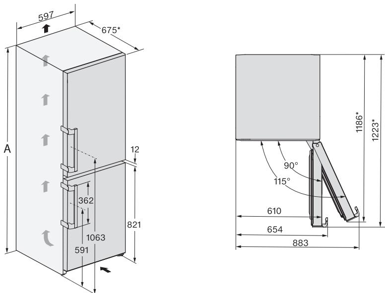
\*Розміри без встановлених дистанційних планок. Під час монтажу дистанційних планок глибина приладу збільшується на 15 мм.
