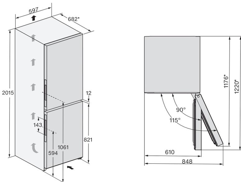
\*Розміри без встановлених дистанційних планок. Під час монтажу дистанційних планок глибина приладу збільшується на 15 мм.
