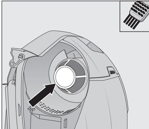
■ Очищте фільтр попереднього очищення та бічні стінки внутрішньої сторони за допомогою інструменту для очищення.
