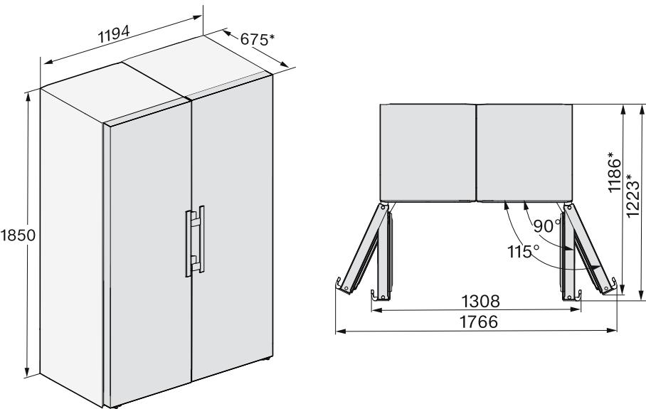
\*Розміри без встановлених дистанційних планок. Під час монтажу дистанційних планок глибина приладу збільшується на 15 мм.
