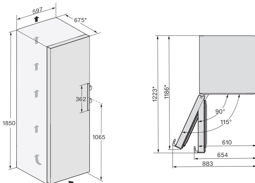
\*Розміри без встановлених дистанційних планок. Під час монтажу дистанційних планок глибина приладу збільшується на 15 мм.
