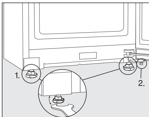
■ Вирівняйте холодильник за допомогою ватерпасу та гайкового ключа, що додається, і підтримайте дверцята приладу.
