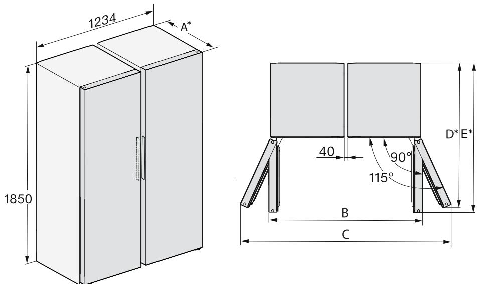
\*Розміри без встановлених дистанційних планок. Під час монтажу дистанційних планок глибина приладу збільшується на 15 мм.
